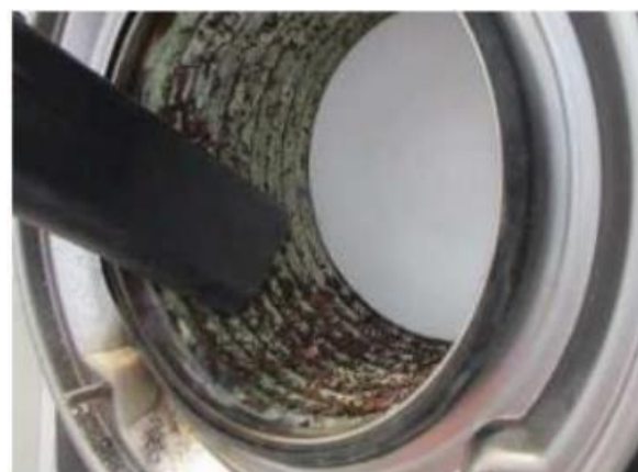
5. Окончательно убрать отложения пылесосом.
